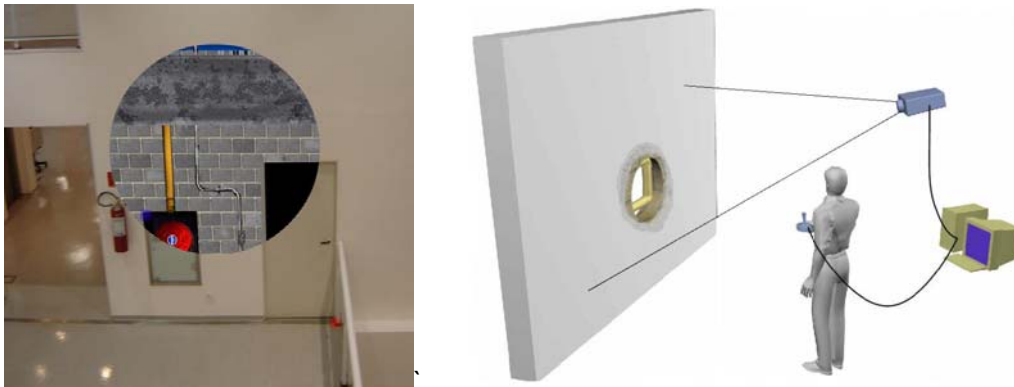
Figura 2: Representação artística do funcionamento do sistema AR X-RAY. (Miranda et. al. 2008)
